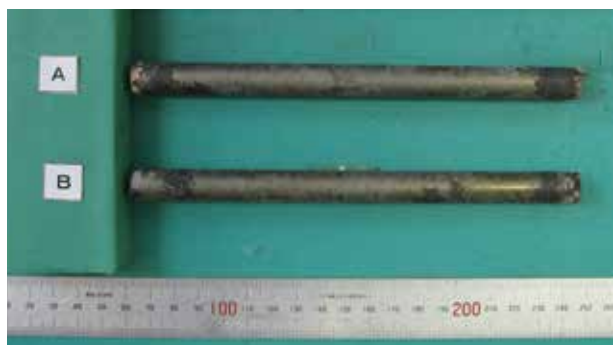
腐食促進試験後の鋼材状況(ESCON)
